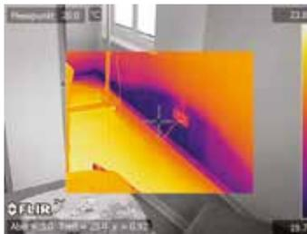
Ce cas de dégât des eaux montre clairement les avantages de la fonction Image dans l'image. Le client comprend facilement où l'image a été prise, alors que ce serait plus difficile avec une image thermique seule.
