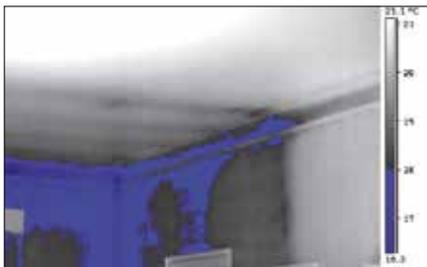
*L'alarme d'humidité relative vous signale les zones où la condensation risque d'apparaître. Dans l'image ci-contre, c'est le cas de la zone en bleu.*
