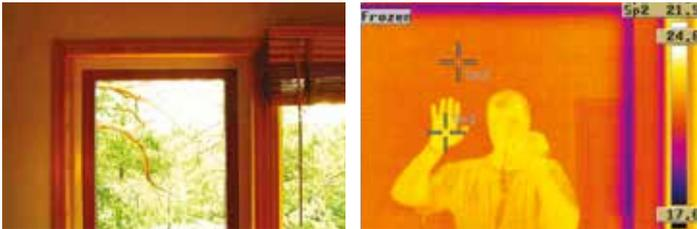
La fenêtre reflète le rayonnement thermique ; elle agit comme un miroir pour la caméra thermique.
