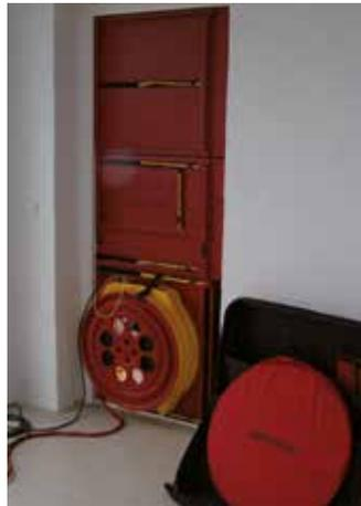
*Le matériel d'essai de pressurisation est généralement installé sur la porte d'entrée.*
