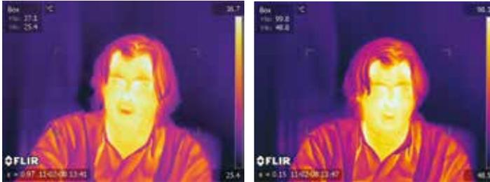
Sur l'image thermique de gauche, l'émissivité est réglée sur la valeur de la peau humaine (0,97). Le relevé de température est correct : 36,7 °C. Sur l'image de droite, une émissivité incorrecte (0,15) produit un relevé de température fantaisiste : 98,3 °C.
