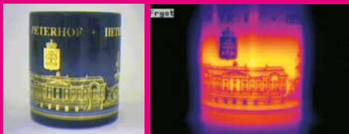
*L'image thermique pourrait laisser croire que la peinture dorée est plus froide que le reste de la surface de la tasse. En réalité, elle est exactement à la même température. La différence d'intensité du rayonnement thermique provient de la différence d'émissivité.*
