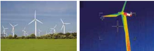
*Image thermique d'une éolienne, prise au niveau du sol*
