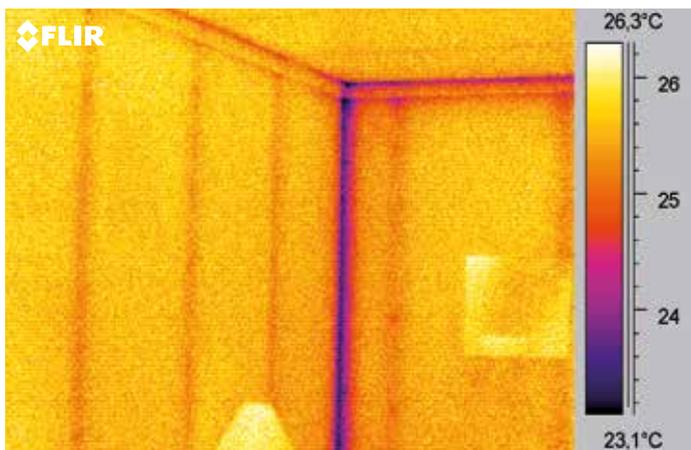
*Image thermique prise de l'intérieur. L'ossature est visible, de même que les vis de fixation du revêtement à l'ossature. Le coin est nettement plus froid. Cet « effet de coin » est normal.*
